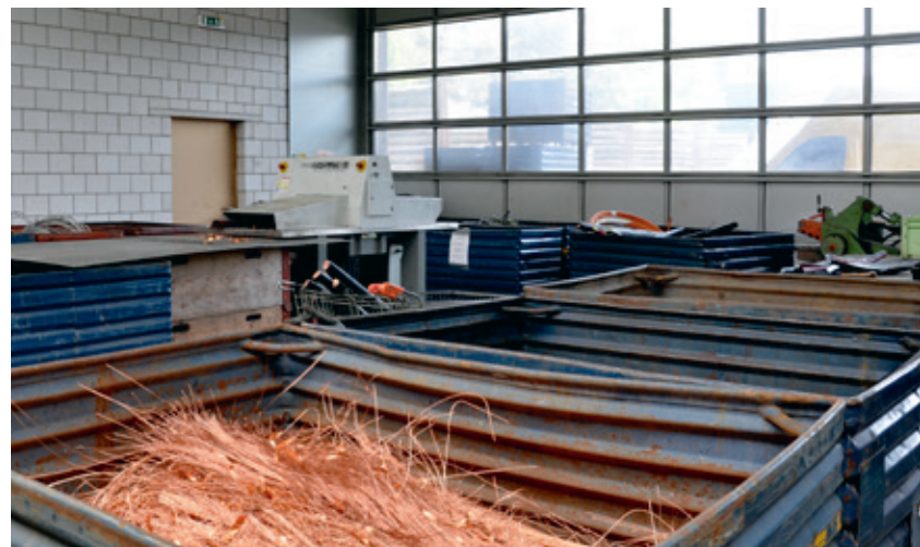
In dieser Halle werden Kabel aufgeschlitzt und deren Inhalt sortiert.
