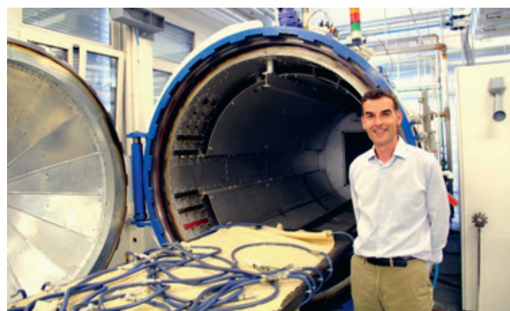
Jon Andri Jörg vor dem Autoklav, in dem die Karbonteile bei 350 Grad gehärtet werden
