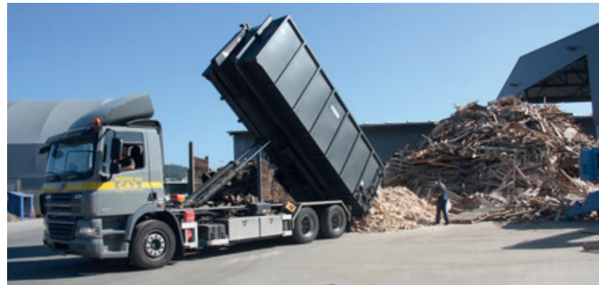
Das angelieferte Holz wird nach Qualität sortiert und zu Spanplatten oder Holzschnitzel weiterverarbeitet.
